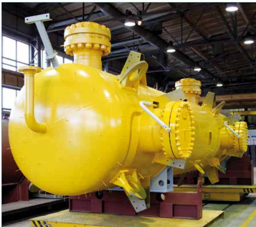
Сепаратор вертикальный ТНГГ-1-Т105 в транспортном положении
